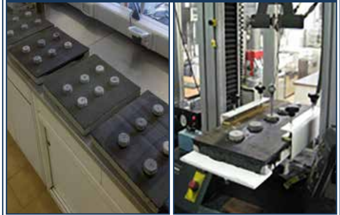
MISURA AL DINAMOMETRO DELLA FORZA DI ADESIONE
