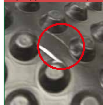
FOGLIO HDPE BUGNATO NON SUPERA LA PROVA
